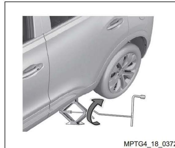
5. Eleve o veículo com o macaco apenas após certificar-se de que não há nenhum passageiro dentro do veículo. Ao elevar o veículo com o macaco, encaixe a alavanca do macaco no macaco e encaixe a chave de roda na alavanca. Gire a chave de roda no sentido horário. Assim que o macaco se encostar no veículo e começar a levantá-lo, verifique novamente se ele está posicionado corretamente.
