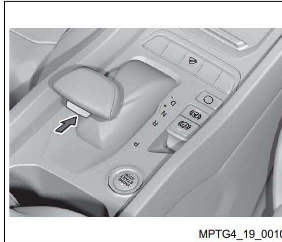
1. Acione totalmente o pedal de freio e pressione o botão na alavanca seletora, mova a alavanca seletora da posição P para a posição de condução.
