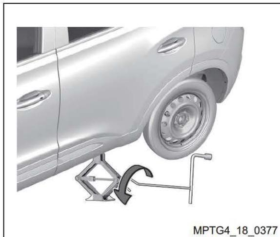
9. Abaixar o veículo completamente e aperte os parafusos da roda. Para abaixar o veículo, gire a chave de roda no sentido anti-horário.
