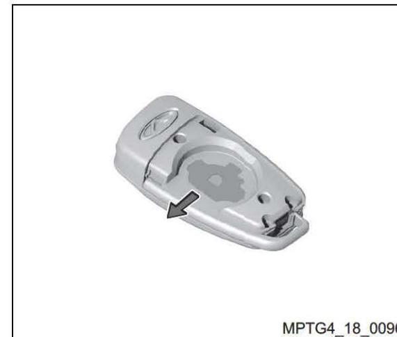
2. Remova a bateria descarregada e substitua pela nova com o lado positivo (+) voltado para cima.
