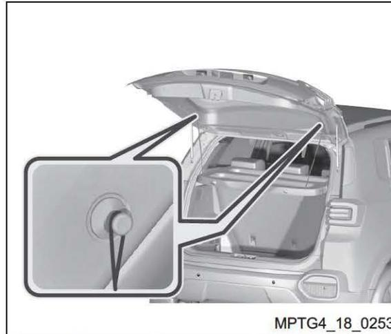
Se a cobertura do compartimento de bagagem não estiver em uso, é possível fixá-la junto à tampa traseira por meio de seu gancho de fixação, para facilitar a acomodação de objetos.
