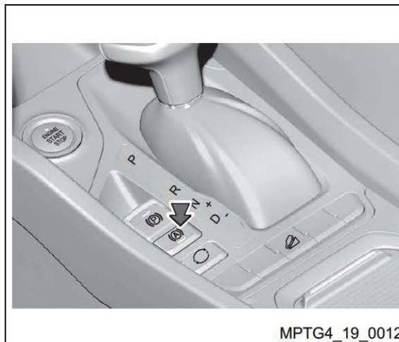
Função de liberação do freio de estacionamento automático:
