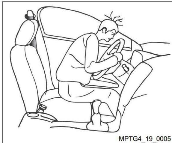
Em caso de acidente ou frenagem de emergência mesmo em baixa velocidade, a desaceleração à qual o corpo é submetido é muito intensa, para que o motorista ou o passageiro dianteiro possam se segurar simplesmente pela força dos braços, o que faz com que os passageiros que não estiverem utilizando ou não utilizarem corretamente os cintos de segurança, sejam arremessados violentamente para frente. Se eles colidirem com quaisquer objetos, podem ser feridos de forma grave ou fatal.
